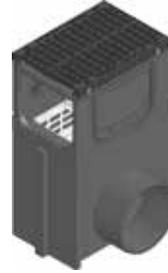
Sumidero con cestillo de acero galvanizado y Reja de fundición dúctil SW 18 mm, negro, clase D 400, cierre de seguridad, tubo con salida PVC-U DN/OD 315
